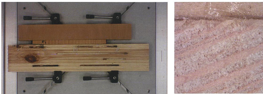
Εικόνα 10. Κάτοψη της συσκευής Lignostation και λεπτομέρεια της δομής των αυξητικών δακτυλίων στο δείγμα
