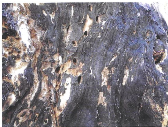
Εικόνα 7. Οπές που οφείλονται σε προσβολή από ξυλοφάγα έντομα
